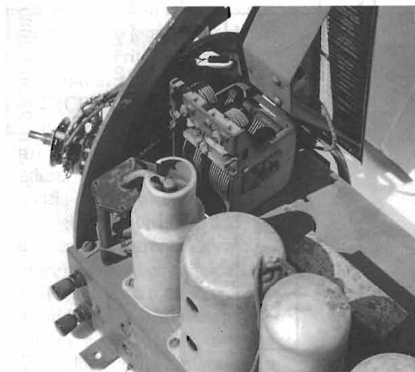
figura 6 - Particolare del variabile con i due compensatori ad aria sovrastanti.
